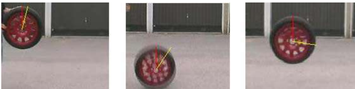
figur 23 - Studsförlopp - 1 utgångsläge, 2 studsögonblick, 3 vändhöjd
