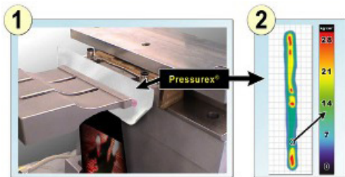
Cuando Pressurex® es colocado entre dos superficies de contacto, su color cambia proporcionalmente de acuerdo a la presión aplicada
